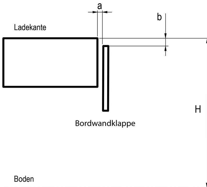
Damit der Winkel der unteren Seite der Verloaderampe so angepasst werden kann, dass sie im richtigen Verhältnis zu Ihrer Ladehöhe steht und somit das parallele Aufliegen auf dem Boden gewährleistet,
