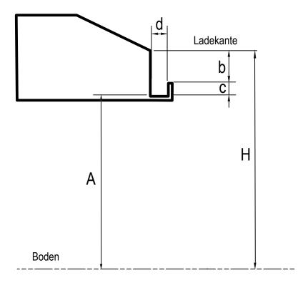
Damit der Winkel der unteren Seite der Verladerampe so angepasst werden kann, dass sie im richtigen Verhältnis zu Ihrer Ladehöhe steht und somit das parallele Aufliegen auf dem Boden gewährleistet,
